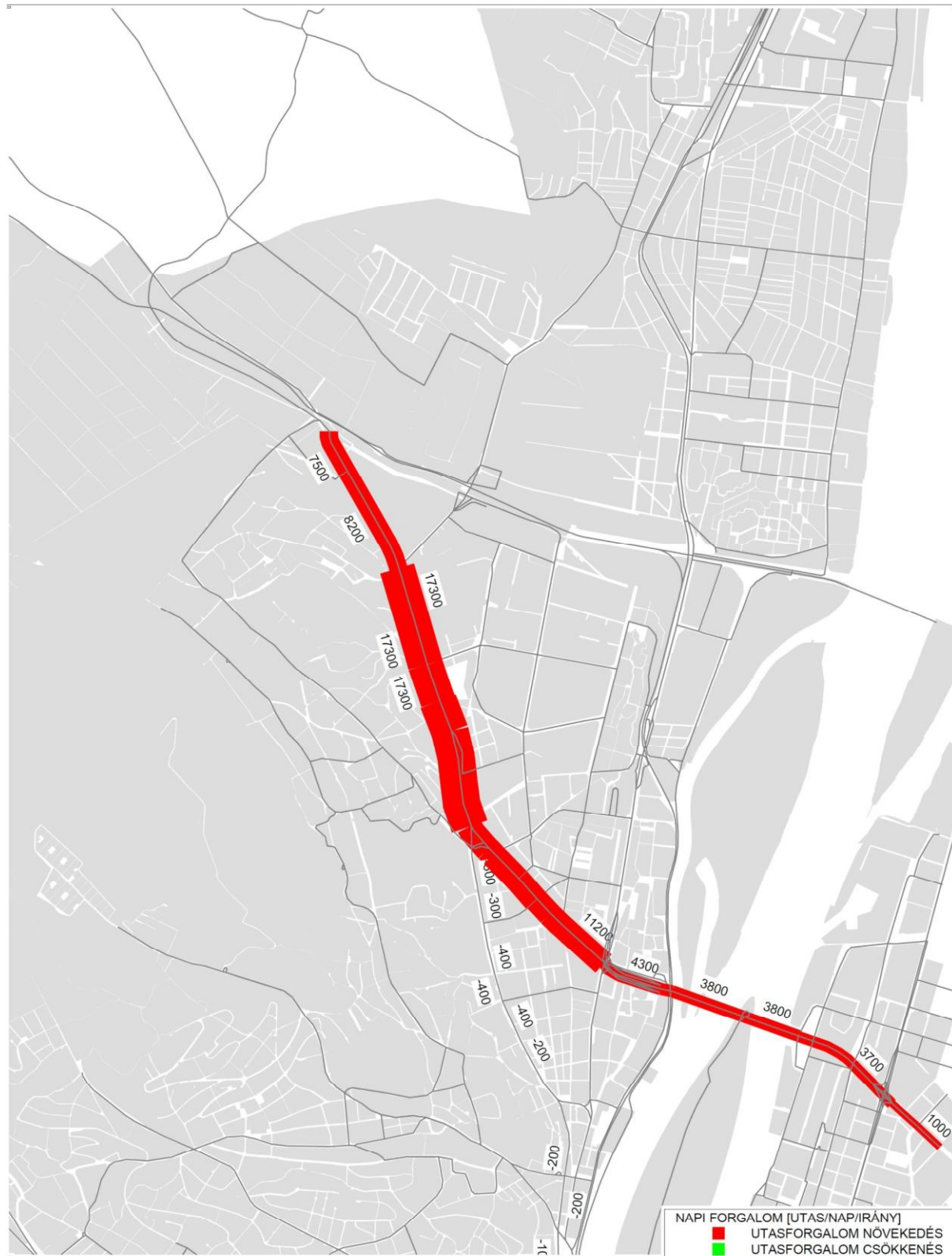
KÜLSŐ BÉCSI ÚTI VILLAMOSVONAL MEGHOSSZABBÍTÁSÁNAK ELŐKÉSZÍTÉSE UTASFORGALOMVÁLTOZÁS A VILLAMOS VONALAKON 2017 - "A" változat
