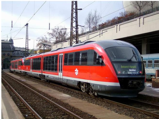
4-1. ábra - Siemens-Desiro motorvonat
