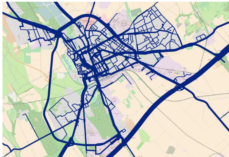
3-50. ábra: Székesfehérvár közútjainak forgalmi terhelése (2016-os állapot)
