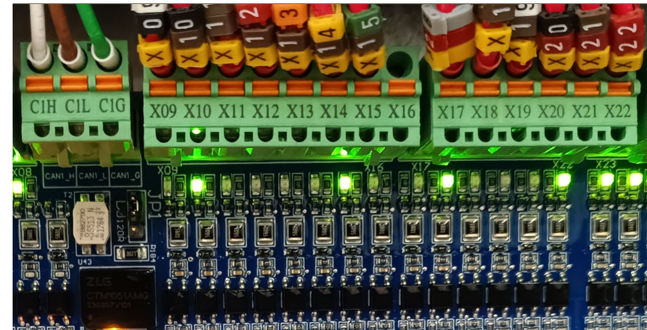
GEC-SF panel, +24VDC optikailag elválasztott bemeneteinek egy része (Álló lépcső)
