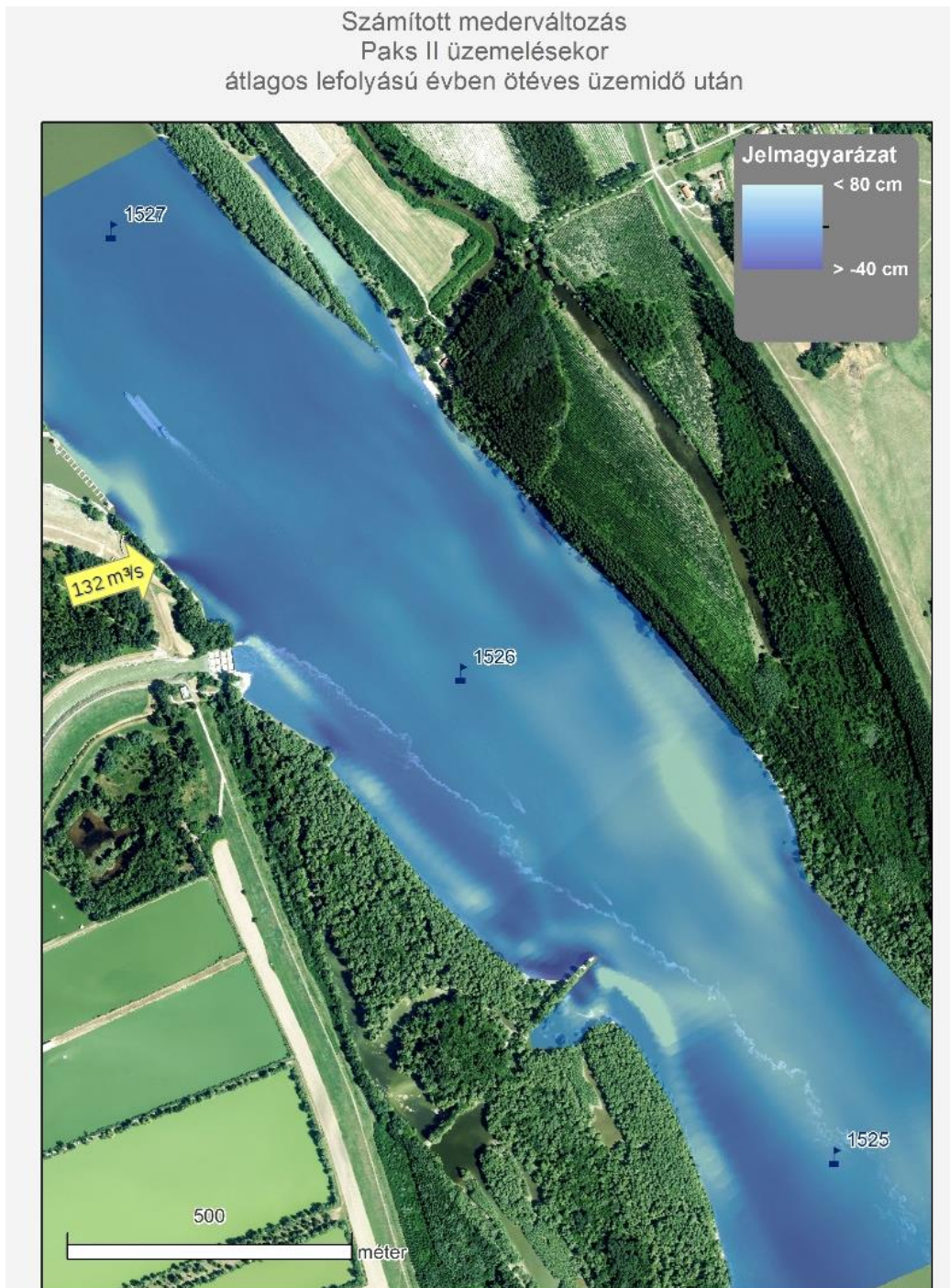
63. ábra: Számított Duna mederváltozások 5 év üzemelés után, 2 300 m 3 /s-os dunai hozam (átlagos hidrológiai év) és 100 m 3 /s-os hűtővíz-kivétel esetén (2037-2085. év közötti állapot) – Paks II. önállóan (2037-2085)
