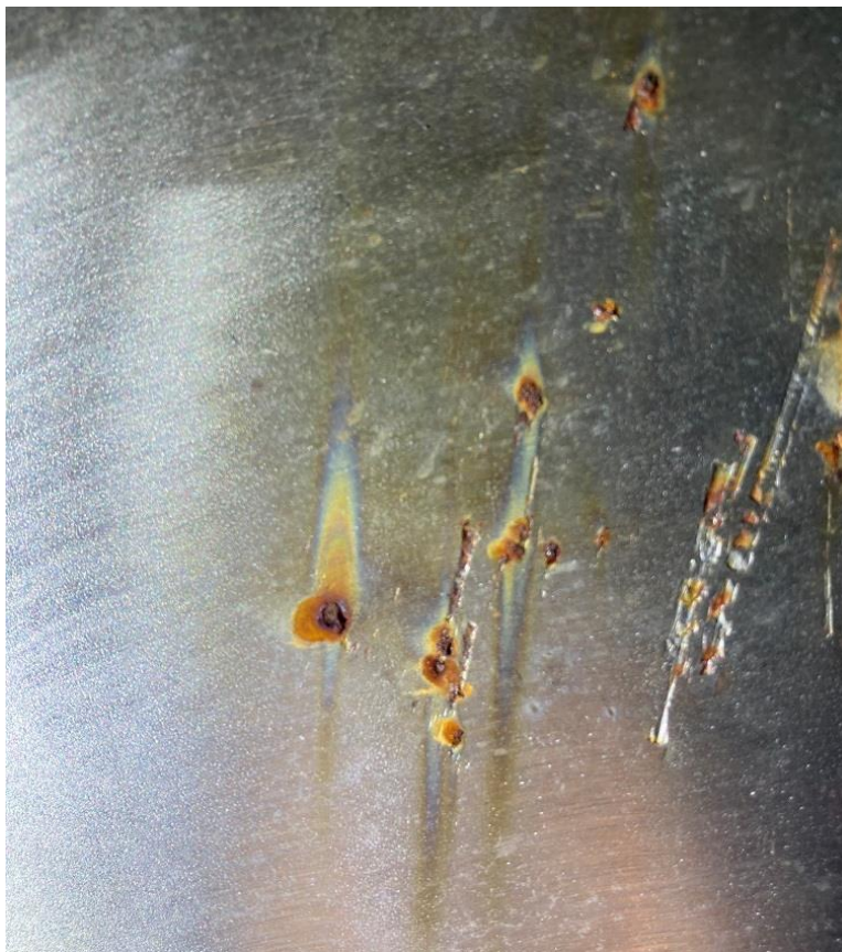
M1-8. ábra. Rozsdafoltok a paláston
