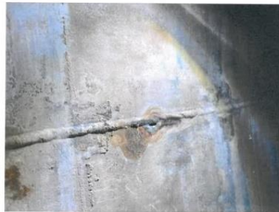
M2-2. ábra. Lyukkorrózió az RA02B001 tartály palástjának hosszvarratán
