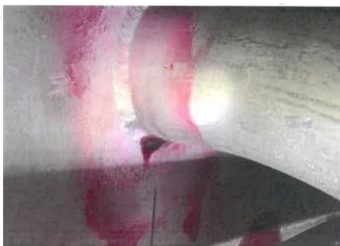
Összeolvadási hiány a C3 jelű csomk varratában.
