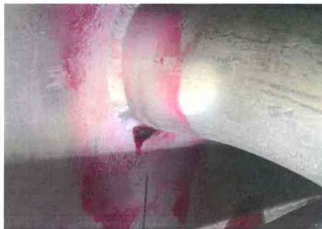
Összeolvadási hiány a C3 jelű csomkú varratában.
