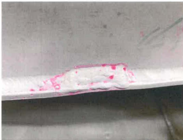
Porozitás a palást alsó körvarratán.
