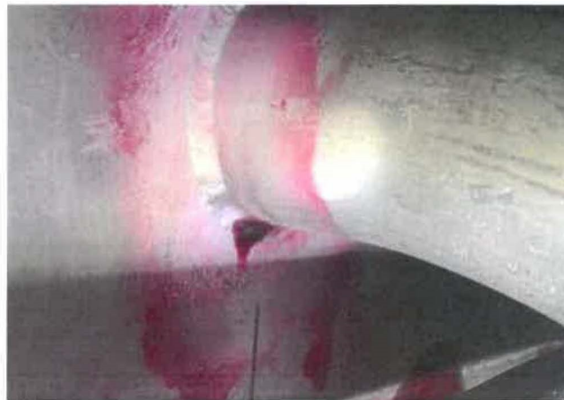
Összeolvadási hiány a C3 jelű csomk varratában.
