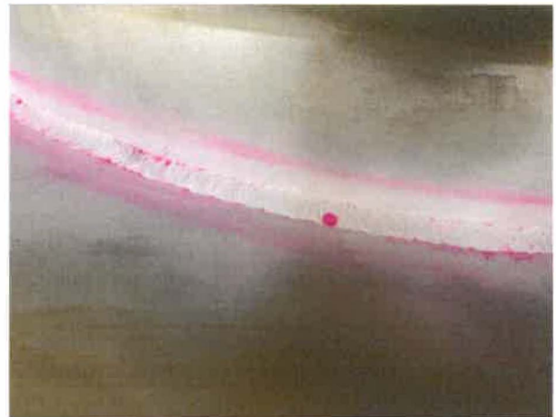
Porozitás a bűvönnyílás sarokvarratán.
