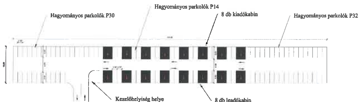
5-7. ábra: 16 kabinos automata rendszer fogadósíntjének elvi elrendezése Forrás: WÖHR GmbH minták alapján Mikroline Kft.
